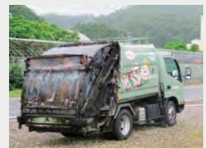
▲テールゲートが焼け焦げた ごみ収集車
