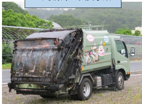
ごみ収集車の火災事故
