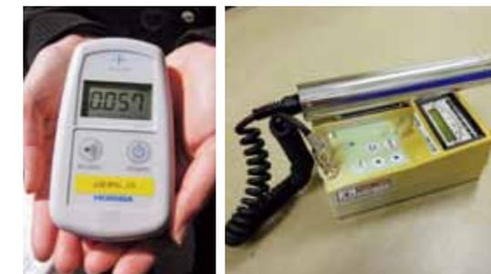
④シンチレーション式放射線量測定器④
