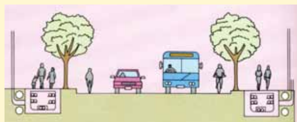
電柱のない「キャブシステム」の道路
