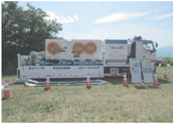
▲災害に備え導入する排水ポンプ車
