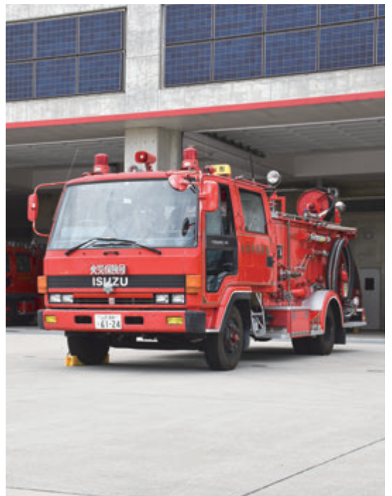
▲車両火災などで出動してきた化学消防ポンプ自動車
