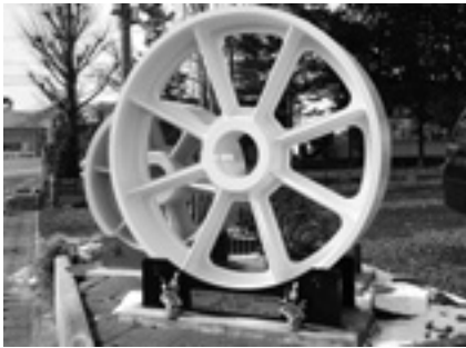
▲スカイツリーのエレベーターは市内企業製の大型滑車を使用
